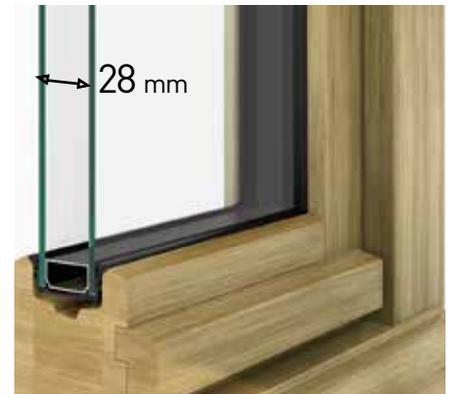
Vitrage 28 mm en base (4/20/4 FE + Argon) Permet de concilier l'utilisation de vitrage technique tout en maintenant un haut niveau d'isolation thermique
